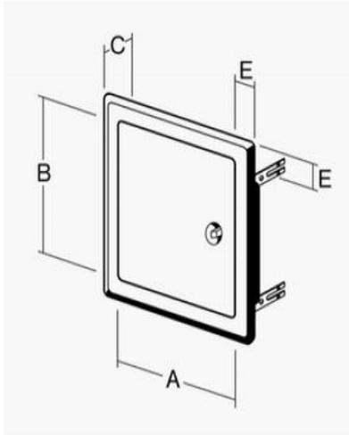
Für Wand- und Deckenmontage in verschiedenen Größen von 150 x 150 mm bis 600 x 600 mm. Hergestellt aus elektrolytisch verzinktem Stahlblech, pulverlackiert. Stabiler Rahmen mit einer minimierten Einbautiefe von 25 mm. Aushängbares Türblatt mit leichtgängigem Spezial-Scharnier aus Metall für Vierkant-Verschluss 7 mm. Montage mittels 6 schwenkbaren Mauerankern.
